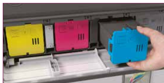
De tonercartridges worden pas uitgeworpen als deze helemaal leeg zijn.
